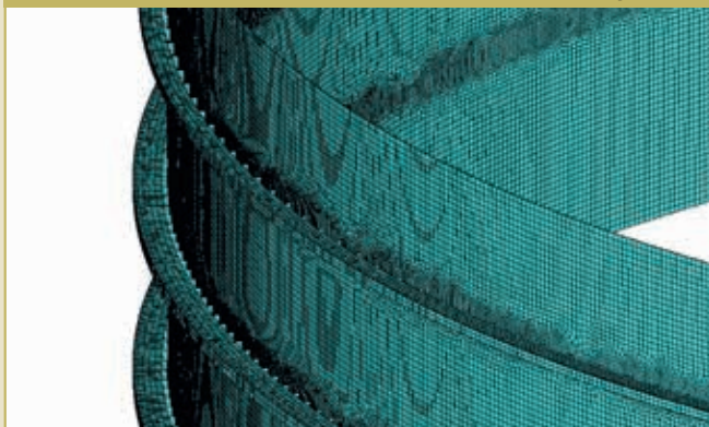
Фрагмент конечно-элементной модели стенки стального вертикального резервуара
