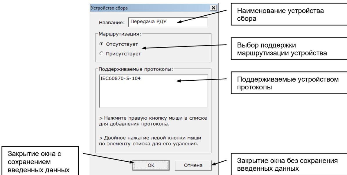
Для добавления поддерживаемых протоколов необходимо нажать правую кнопку мыши на списке протоколов и выбрать из всплывающего меню необходимый протокол. Для удаления типа протокола из списка, поддерживаемых данным измерителем, необходимо два раза щелкнуть левой кнопкой мыши по названию протокола.
