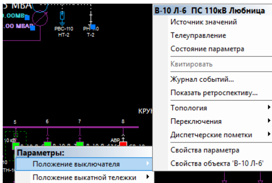
Рисунок 22 – Контекстное меню управления выключателем с выкатной тележкой
